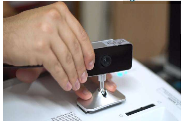
(9) Ajuste o sensor para que a imagem do projetor fique entre as linhas vermelhas
